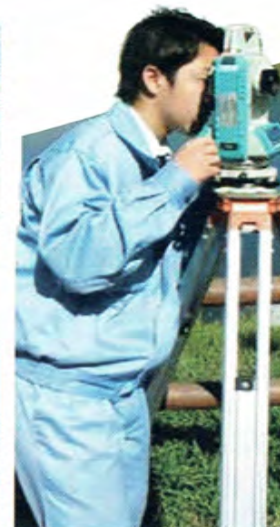
▲実習（セオドライトを用いた角測量）
