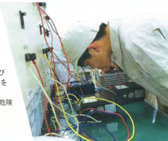
▲電機検の特性試験（機器実習）
